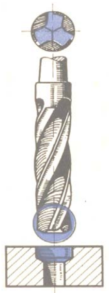
شكل (٦-٧): المخوش الحلزوني والشكل النهائي لقطعة العمل ومجاري الرائش الثلاثي
