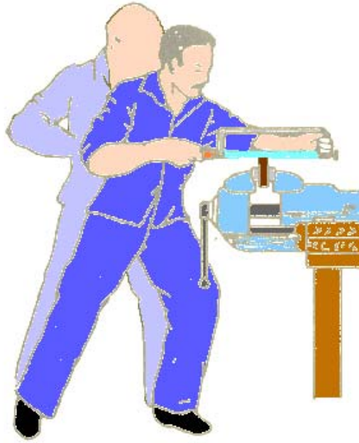
شكل (٦-٤): الوضع الصحيح للجسم أثناء عملية النشر
