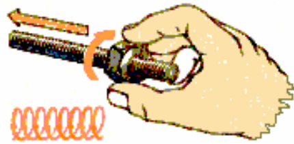
استخدام الصامولة لاختبار اللولبة الخارجية
