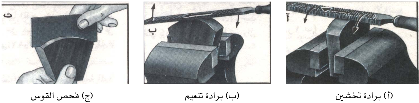
شكل (٨-٥): كيفية برادة الأسطح المستديرة
