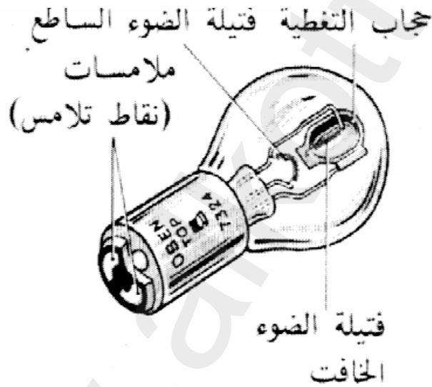
شكل رقم ( ٣ ) يوضح مكونات مصباح الإنارة
