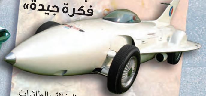
كما تم استبدال الطائرات النفاثة بالطائرات التي تعمل بالمراوح، حاول بعض الصناع استخدام المحركات النفاثة في السيارات، مثل محركات جنرال فايربيرد 1 (Firebird 1) لعام 1953. ولكن حتى المحركات النفاثة الصغيرة كانت قوية جداً لاستخدامها على الطرقات.
