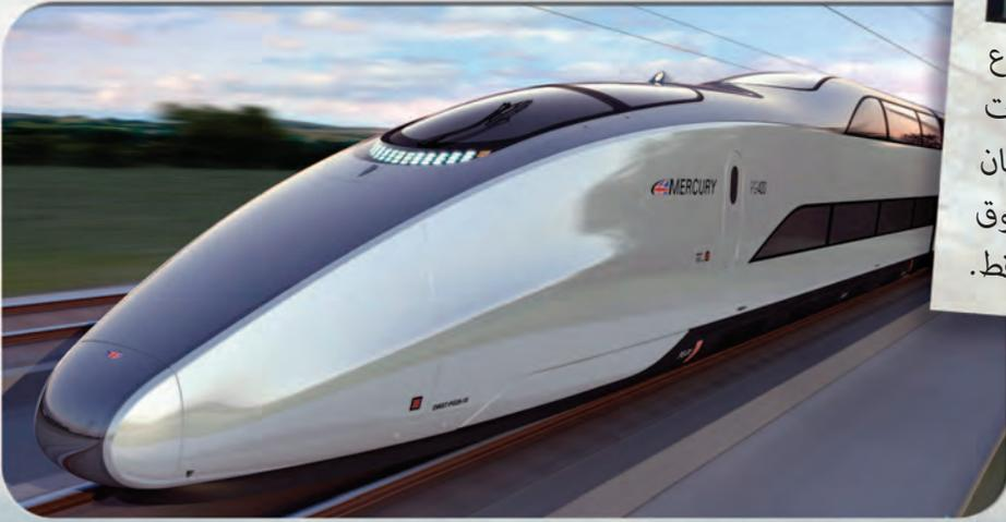
سيكون بمقدور قطار «الزئبق» السريع ذي الطابقيين السير بسرعة تبلغ نحو 225 ميلاً في الساعة (362 كم/ ساعة) على قضبان السكك الحديدية في بريطانيا في غضون عشرين عاماً. فهو يستخدم التقنية الكهربائية ذات الكربون المنخفض، ويتميز بشكل أنيق، ومقصورات خاصة لسفر المجموعات، ويوجد فيه حتى مركز تجاري صغير.
