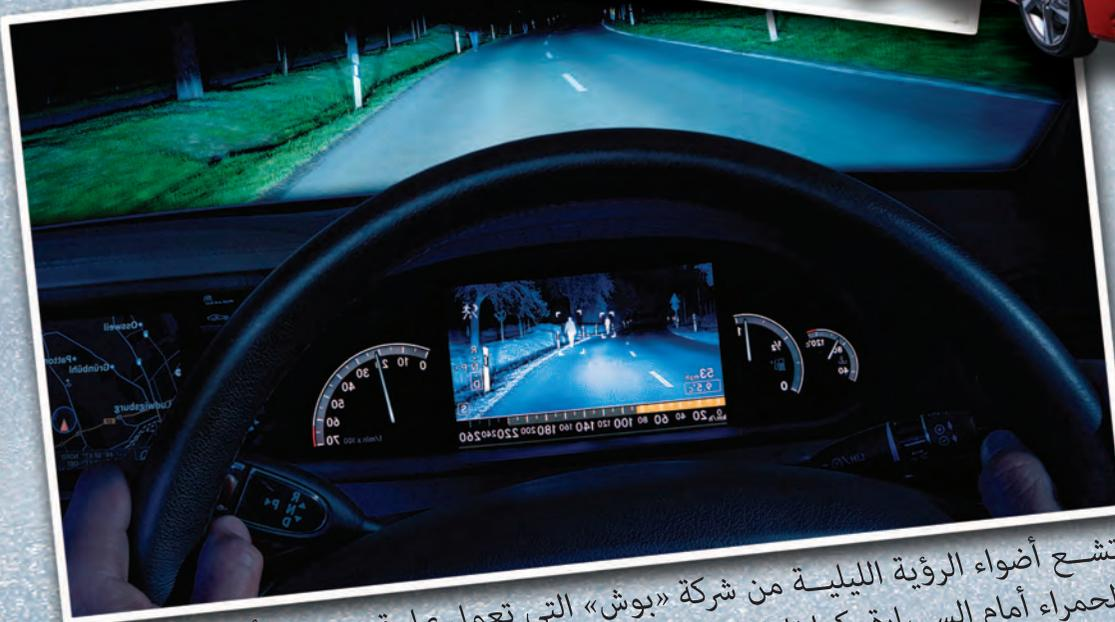
تشع أضواء الرؤية الليلية من شركة «بوش» التي تعمل بما يقرب من الأشعة تحت الحمراء أمام السيارة. كما تلتقط كاميرا بالقرب من مرآة الرؤية الخلفية الانعكاسات المخفضة التوهج وتعرضها على الشاشة.
