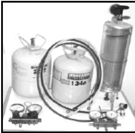
شكل (٣- ٨) مجموعة الشحن ووحدة استعادة وسيط التبريد
