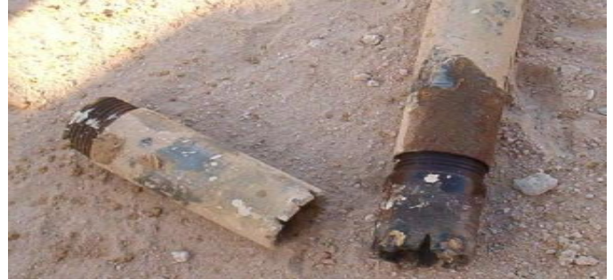
7- ربط فدية القطع في ماسورة الكور لأستخدامها في الحفرة واخذ العينات التي تدخل للكور
