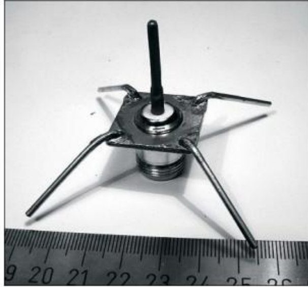
شكل 4.8: الهوائي المسطح ذو ربع طول الموجة.
