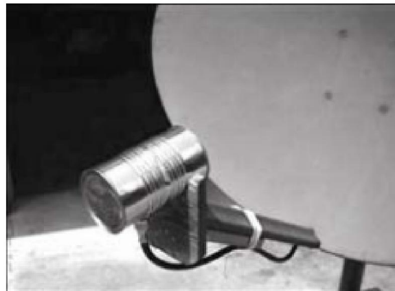
شكل 4.10: هوائي قرني مصنوع من علبة كونسروة معدنية.
