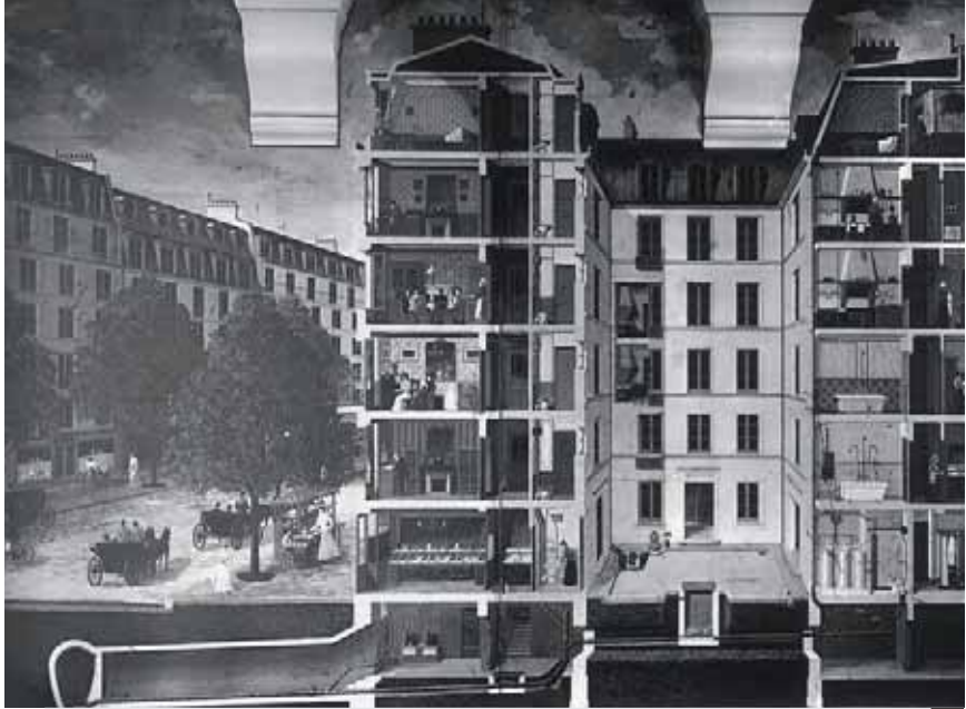
باريس، نحو عام 1900. يصور هذا الرسم شبكة صرف صحي (متصلة مباشرة بالمجاري العامة) لمبنى راقي، وهي تعد من مميزات الثورة الصحية.
