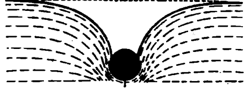
شكل رقم (٩٦) الإبرة الطافية على سطح الماء . الصورة اليمنى - المقطع العرضي للإبرة ( سمك ٢ مم ) والشكل الدقيق للأثر الذي تخلفه على سطح الماء . الصورة اليسرى - طريقة لجعل الإبرة تطفو على سطح الماء باستخدام قطعة من ورق السجاير
