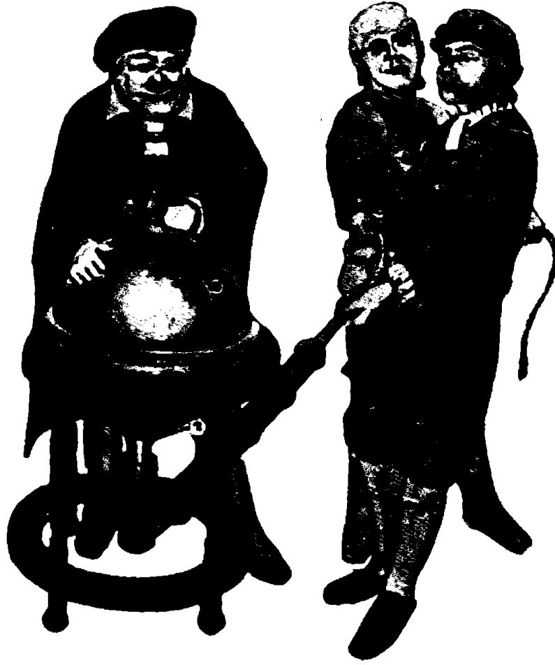
شكل رقم ( ٤ ) فون جيريكه يستخدم منفخته الهوائية لامتصاص الهواء من بين نصفي الكرة النحاسية المجوفة
