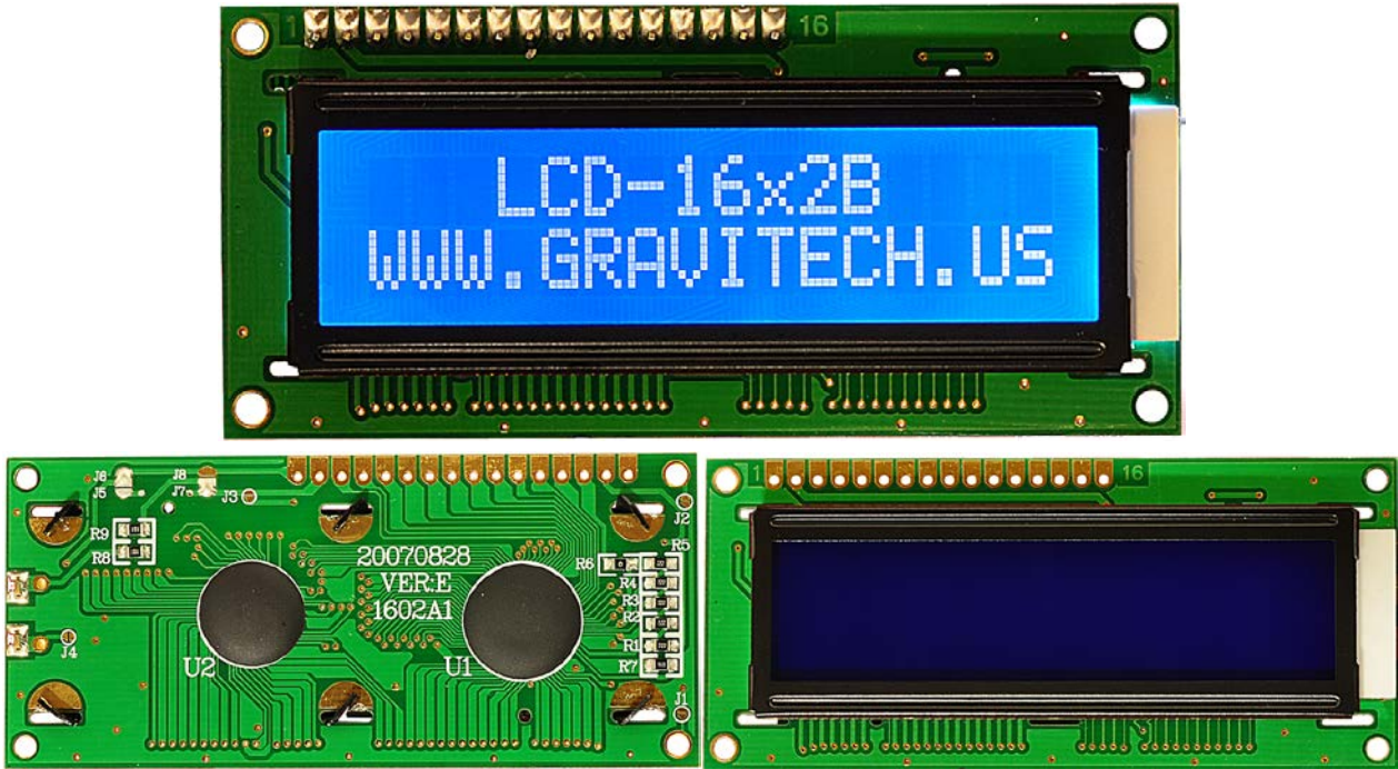
الشكل 6-1 شاشة إظهار كريستالية محرفية ذات قياس 16 x 2
