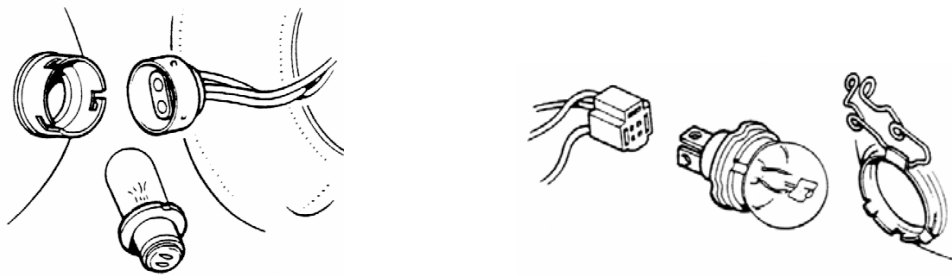
الشكل رقم ( ٧ ) يوضح طريقة تركيب توصيلات مصابيح الإنارة المستخدمة بالسيارة
