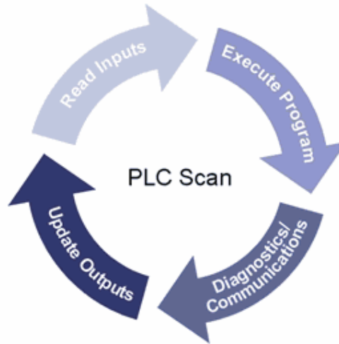
الشكل (٢-٤) دورة عمل أجهزة PLC
