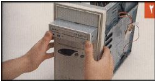
٢ - باستخدام مفك صواميل ، انزع الغطاء الموجود أمام فتحة القرص في واجهة الحاسب ، بعد ذلك أدخل محرك الأقراص في مكانه.
