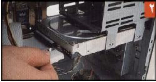
٢ - قم بإيصال كبل الكهرباء بمؤخرة القرص الصلب .
