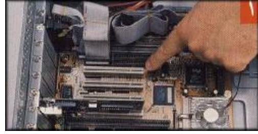
٣ - ضع بطاقة الفيديو في فتحة التوسعة أضغط فوق الحافة العلوية للبطاقة بلطف وتساو لكي تدخلها في فتحة التوسعة .
