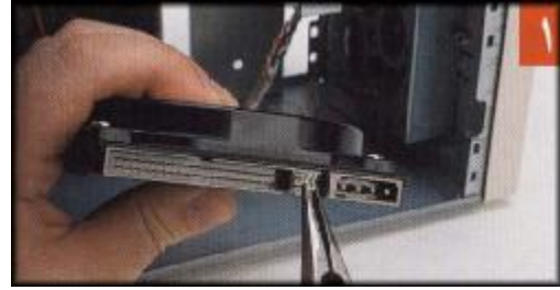
١ - قم بتعديل وصلات العبور (Jumpers) على القرص الصلب ثم قم بدفع القرص الصلب لإدخاله في المكان المخصص له .
