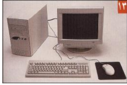
١٣ - قم بتوصيل لوحة المفاتيح ، والفأرة وكذلك قم بتوصيل الشاشة .
