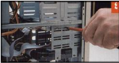
٤ - أربط محرك الأقراص المرنة بالمسامير (البراغي) لتثبيتته في الفتحة المخصصة له .
