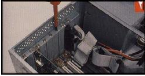
٤ - ثبت بطاقة الفيديو في مكانها باستخدام المسامير الصغيرة.
