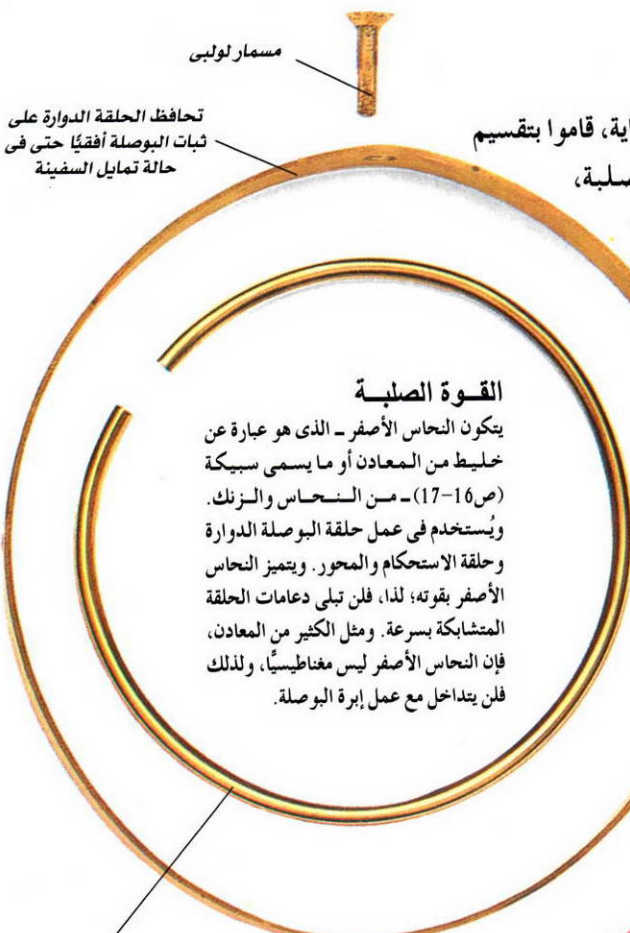
تثبت حلقة الاستحكام البوصلة في علبيتها وتبقيها أسفل الزجاج
