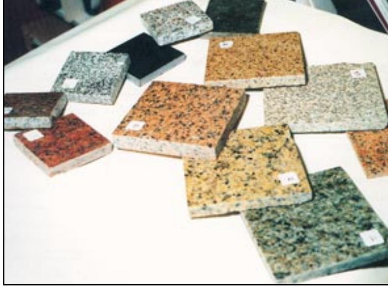
صورة فوتوغرافية لعينات من الرخام المنزلي مصنعة من الصخور الجرانيتية التي ينبعث منها غاز الرادون بنسب متفاوتة
