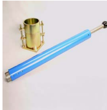
شكل (١٠,٣) جهاز الدمك وجهاز الاختراق المستخدمان في اختبار التحميل النسبي.
