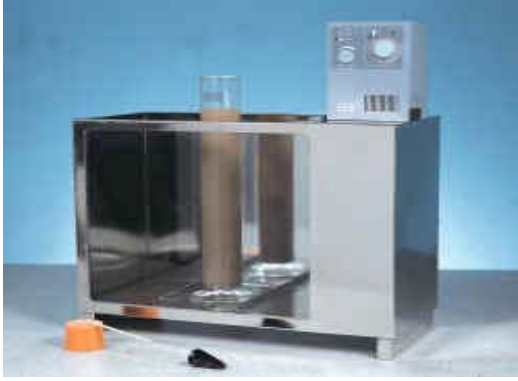
شكل (٢,٣) اختبار الهيدروميتر.
