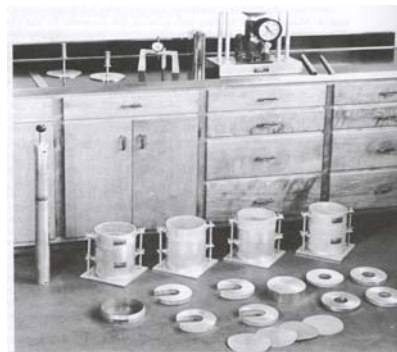
شكل (١٠,٣) جهاز الدمك وجهاز الاختراق المستخدمان في اختبار التحميل النسبي.
