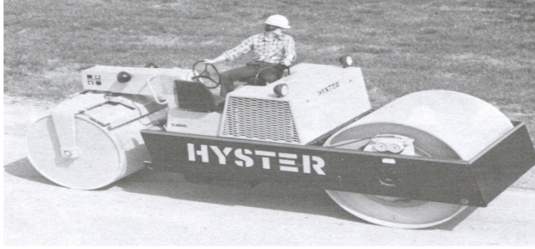
شكل (١٥,٣) نموذج من هراسات ذات العجلات الفولاذية المساء.
