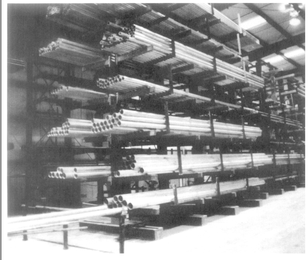
شكل (٦-٣) : رفوف كابولية لتخزين المواد الطويلة مثل الأنابيب
