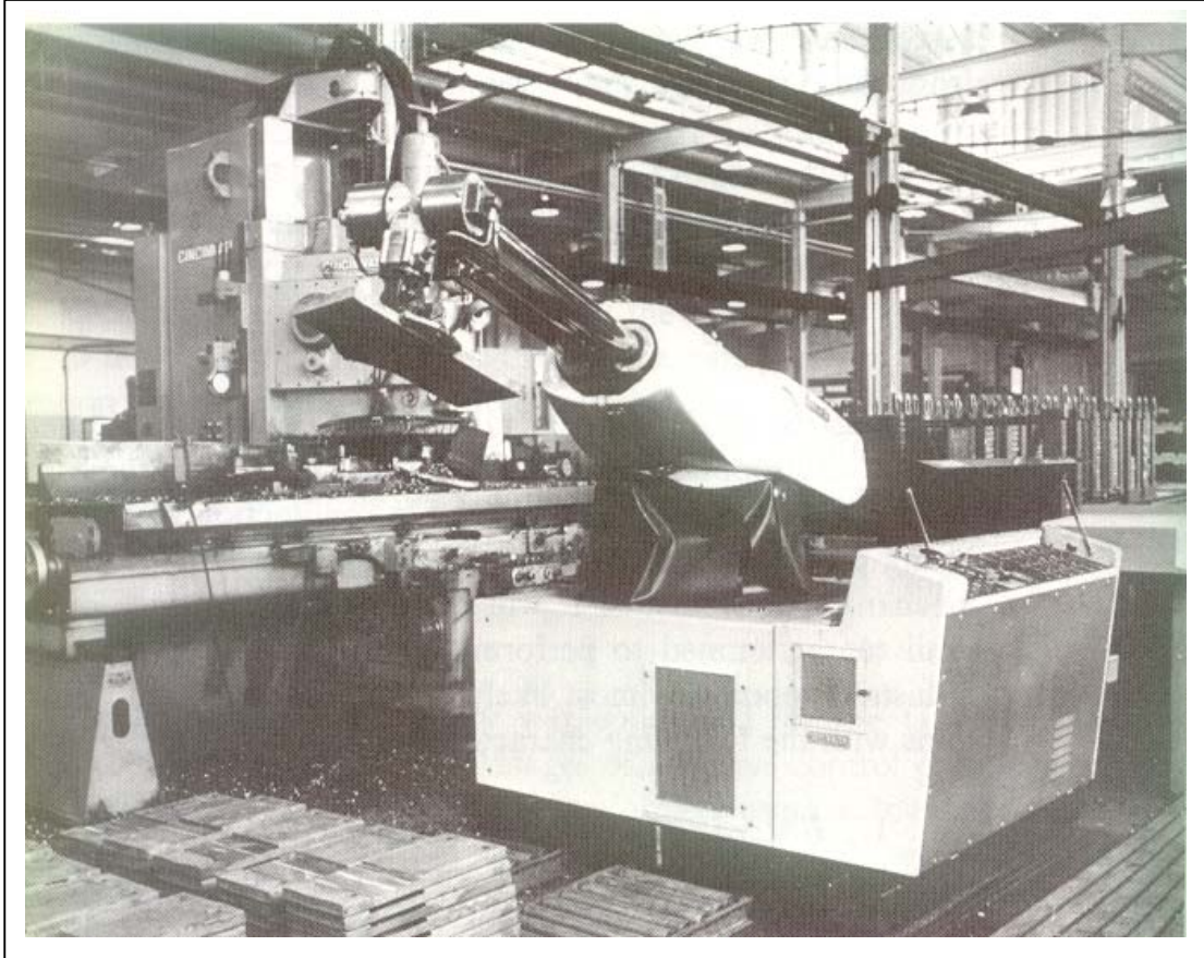
شكل (٥-٣) : مثال لاستخدام روبوت صناعي في عملية مناولة على ماكينة تقريز
