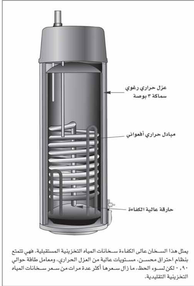
شكل رقم (٣-٦) سخان مياه تخزيني متطور
