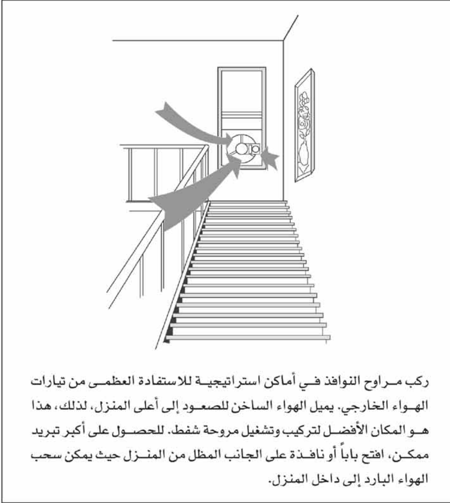
شكل رقم (٤-٨) مراوح التهوية التي تتركب في النوافذ
