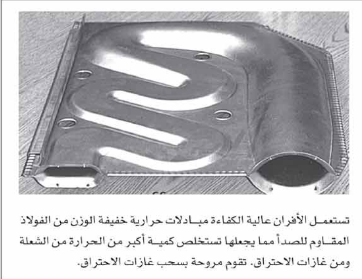
شكل رقم (١٠-١١) مبادل حراري متطور يستعمل في الأفران عالية الكفاءة
