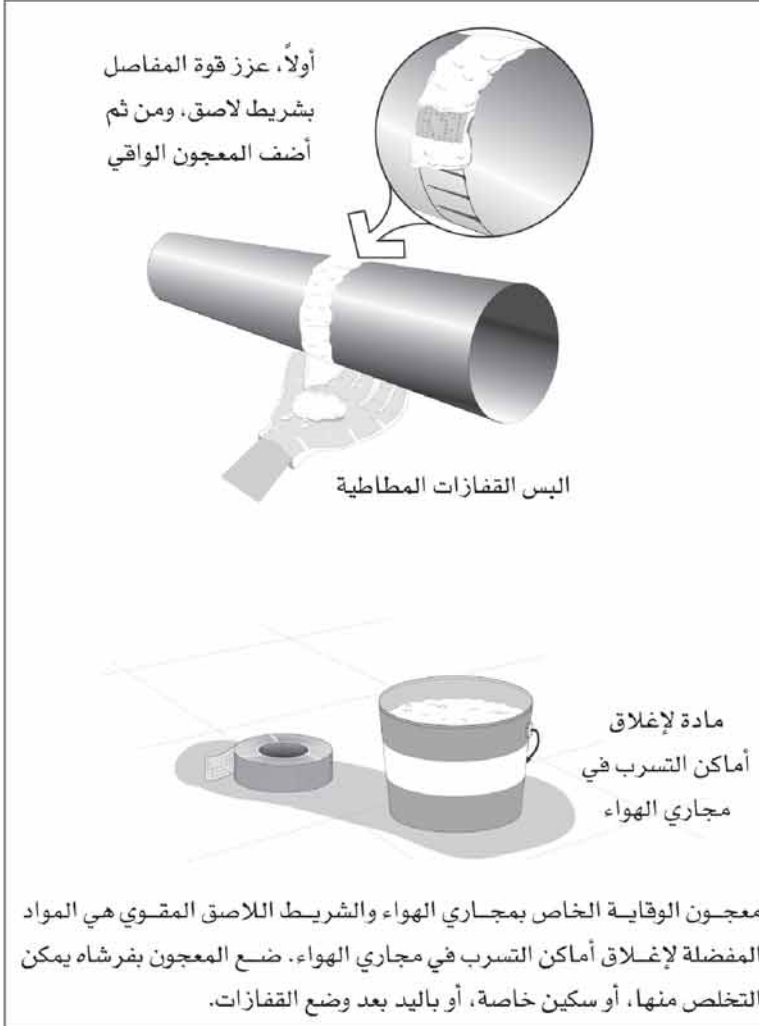
شكل رقم (٧-١٠) إحكام إغلاق مجاري الهواء بمعجون واق وشريط لاصق
