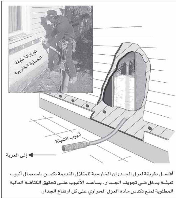
شكل رقم (٧-١١) عزل حراري شبه سائب عالي الكثافة يستعمل للجدار
