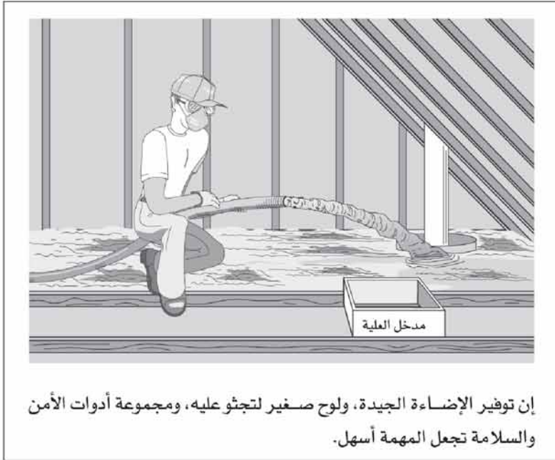
شكل رقم (٧-١٠) تنفيذ وتركيب العزل الحراري في العلية
