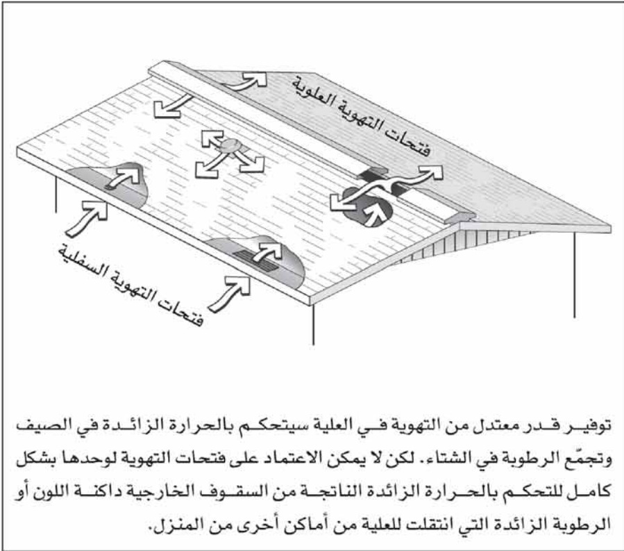
شكل رقم (٧-٧) تتخلّص فتحات التهوية في العلية من الحرارة والرطوبة
