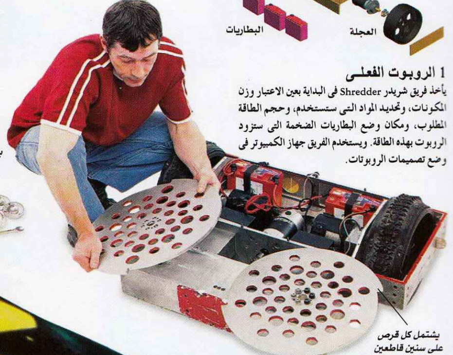
تتسم العجلات بالصلابة، وهي غير معبأة بالهواء لتجنب الثقوب
