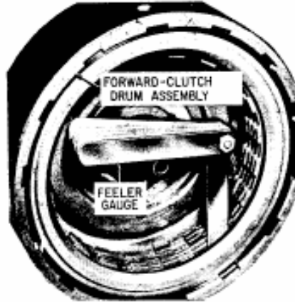
شكل ٤ - ٣ قياس مقدار الخلوص بين أقراص الضغط أقرب إلى أقراص القوابض
