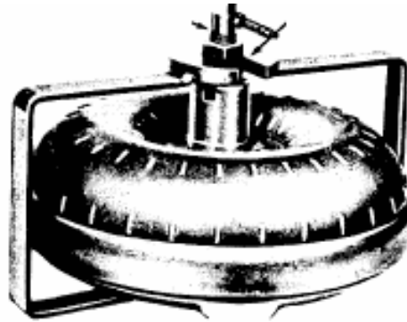
شكل ٢ - ٥ جهاز البحث عن التهريب مزود بصمام الهواء مركب على محول العزم
