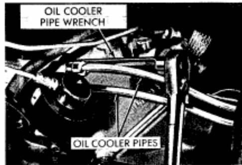
شكل ١٩ - ٣ التوصيلات الخاصة بدورة تبريد ناقل الحركة الأوتوماتيكي
