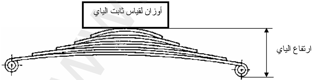
شكل - ١٨٤ كيفية قياس ثابت الياي الورقي
