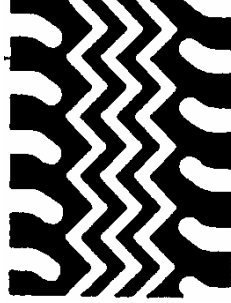
شكل - ٩٧ مداس الإطار على شكل المضلع المربع
