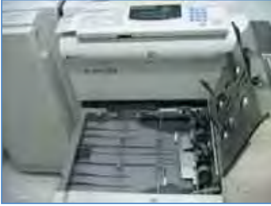
الشكل ( ٢٧ ) عجلات وأسطوانات تغذية ونقل الورق
