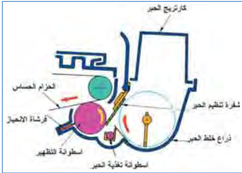
الشكل (٦) مكونات وحدات التظهير أحادي العناصر
