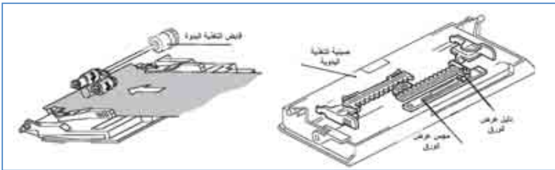
الشكل (٢) صينية التلقيم اليدوي ومكوناتها
