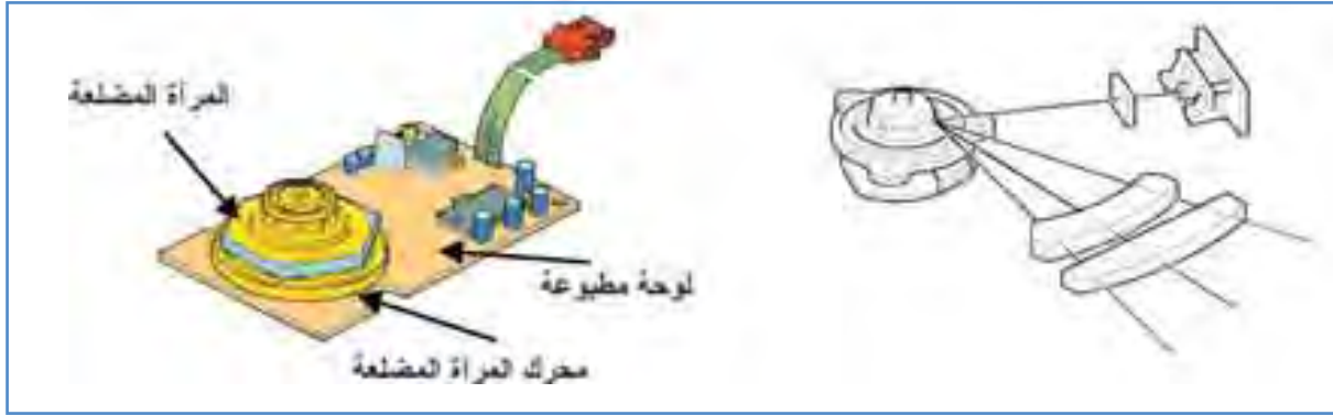
الشكل (١١) المرآة المضلعة الدوارة
