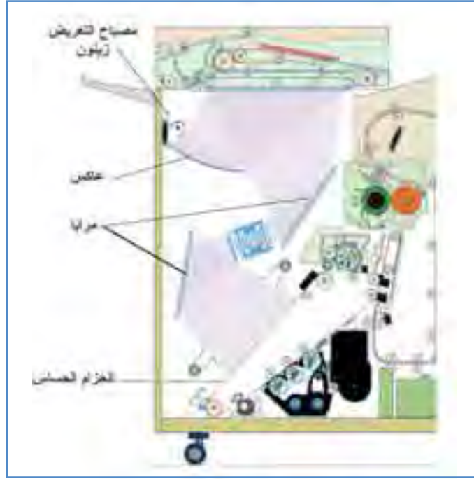
الشكل (٦) يظهر آلية التعريض الضوئي لآلة تصوير بالبصريات الثابتة
