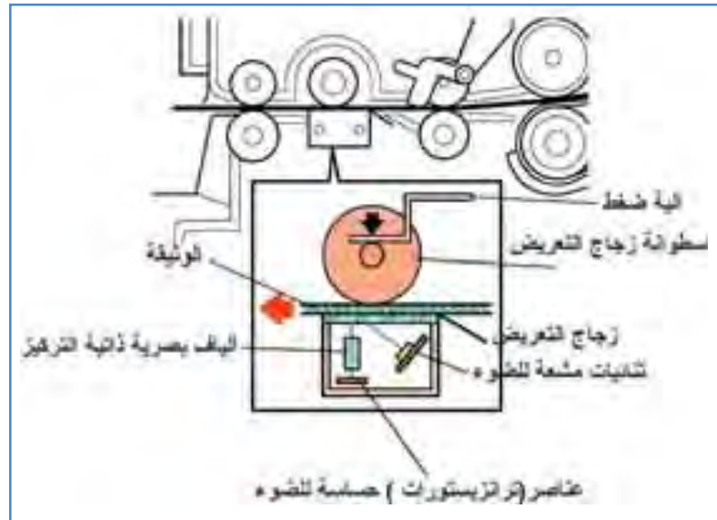
الشكل (٦) آلية المسح الضوئي الرقمي المباشر بالألياف البصرية
