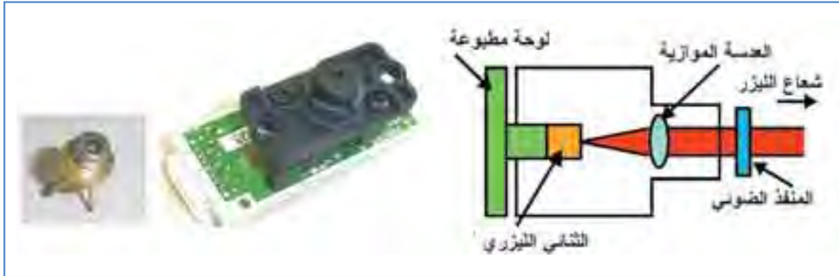
الشكل (٩) آلية الطباعة الليزرية
