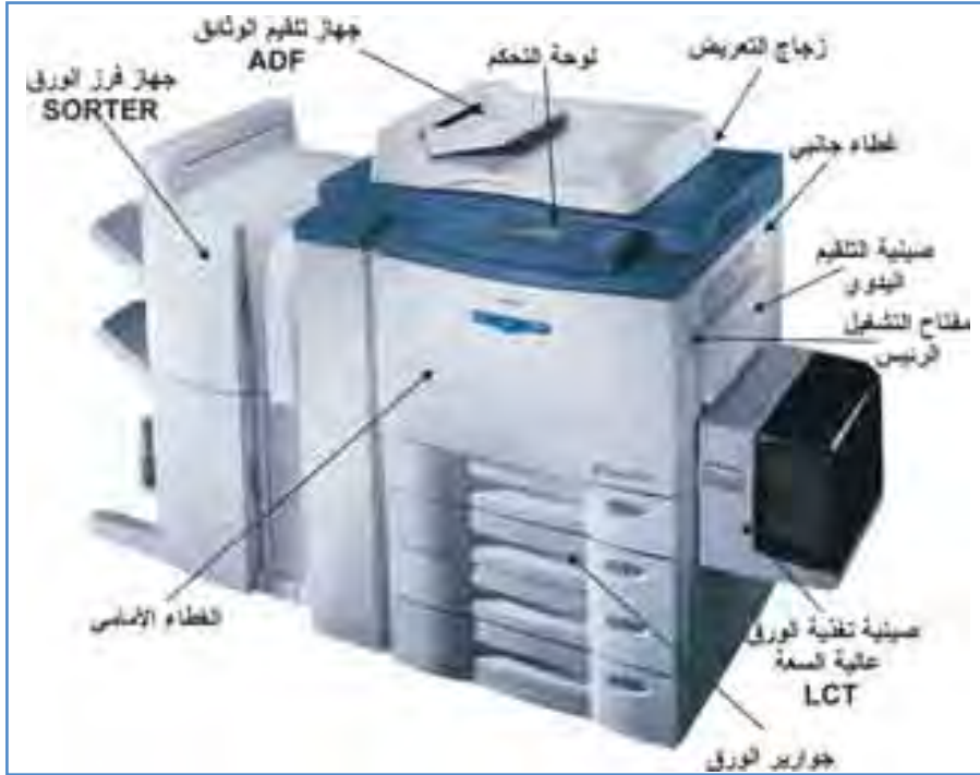
الشكل (١) المكونات الخارجية لآلة تصوير الوثائق
