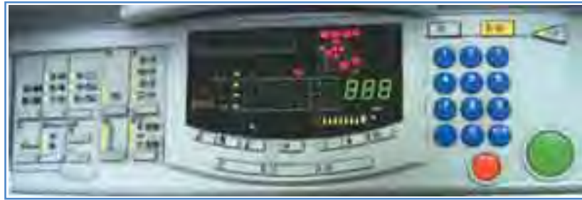
الشكل (١) المؤشرات الضوئية على لوحة التحكم
