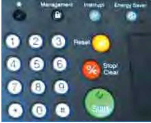
الشكل (٣) نموذج للوحة مفاتيح آلة تصوير الوثائق
