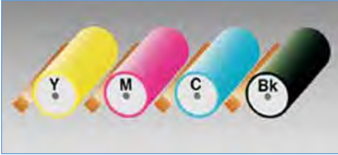
الشكل (١٠) نظام التظهير الملون الرباعي
