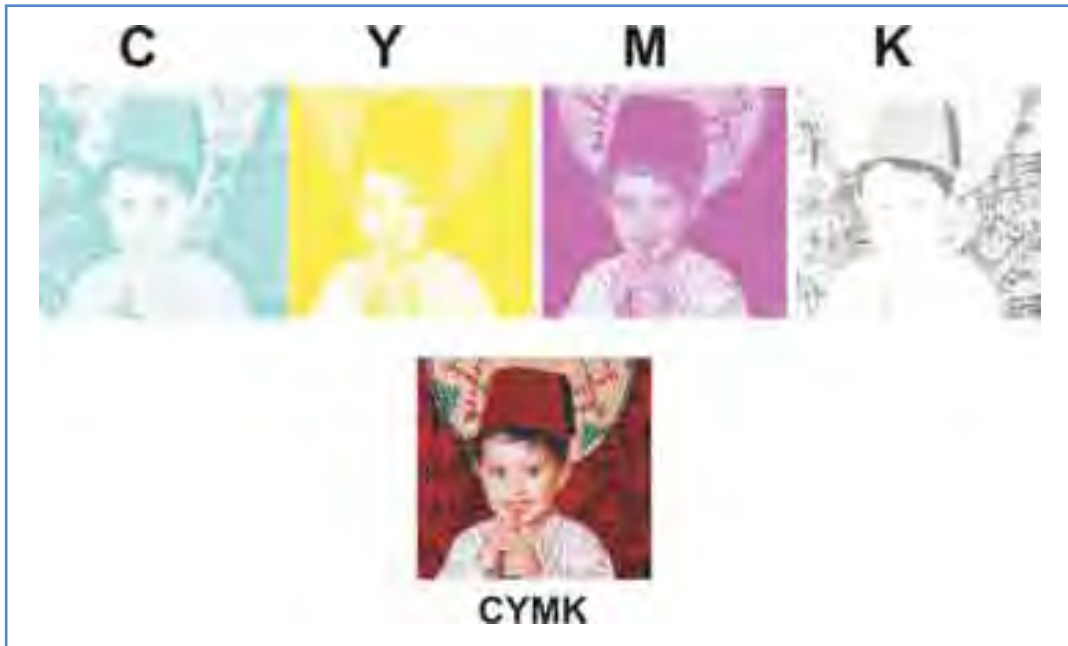
الشكل (٤) الآلات الملونة تستخدم أربعة ألوان لإنتاج النسخة الملونة
