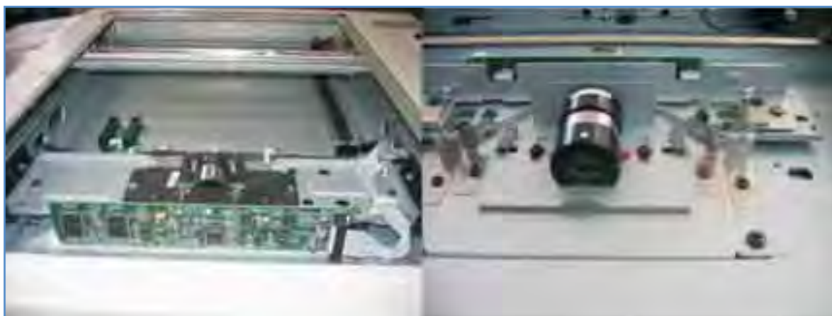
الشكل (٣) الماسح الضوئي الرقمي بالعدسات والمرآيا ووحدة (CCD)
