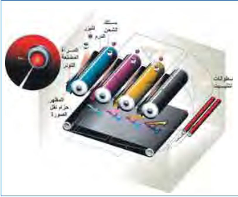
الشكل (١٢) مكونات الطباعة الليزرية الملونة
