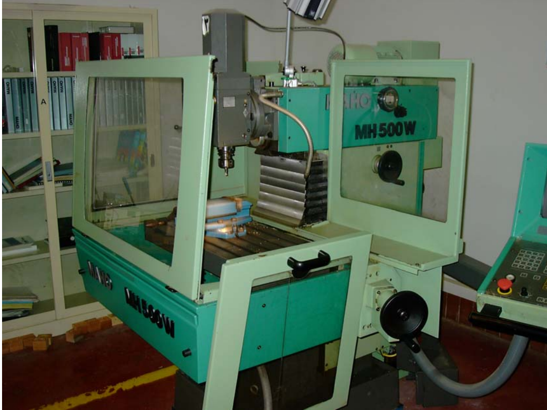
شكل (١- ٦) : فريزة (CNC) من نوع (MH 500 W) بنظام تحكم MAHO 232
