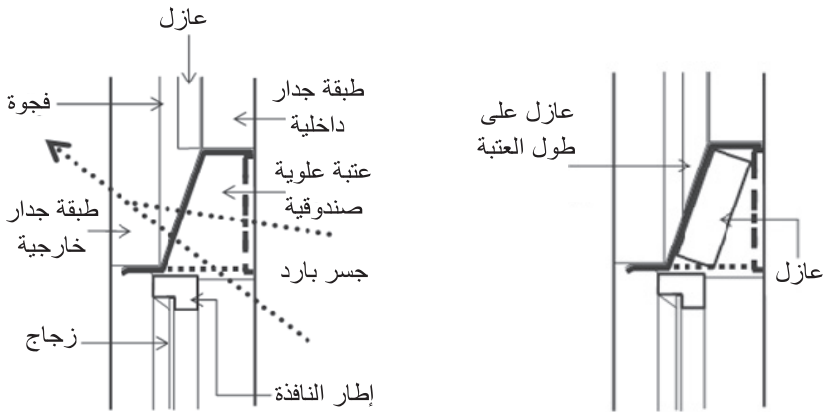
الشكل 10.10 جسر بارد وإنهاءات لتقليل مفعوله في الفقد الحراري.
