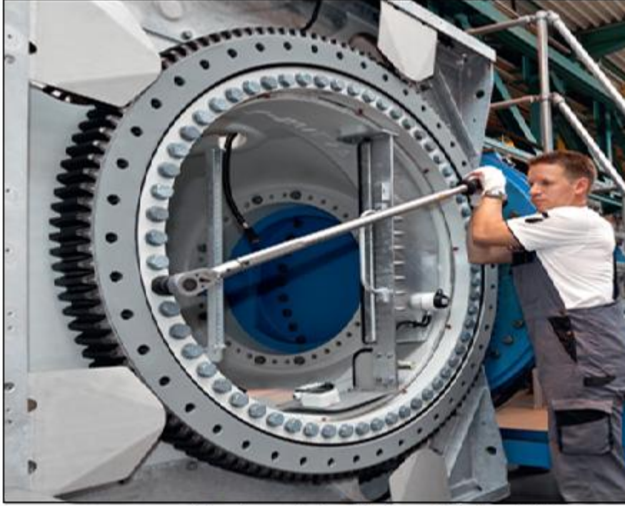
الشكل رقم (١٣ - ب): التريبط على مسامير تثبيت
