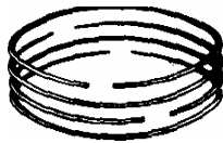
شكل ١ - ١١ يوضح شكل شنبر الزيت مصنعة من رقائق من الفولاذ
