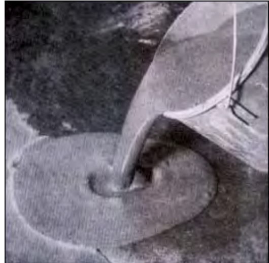
عرض تدفق النايتوفلور ليفل توب يظهر تدفق عالي للحصول على طبقة إسمنتية تحتية مميزة بالإستواء الذاتي بسماكة من ٠,٥ إلى ١٠ ميليمتر.
