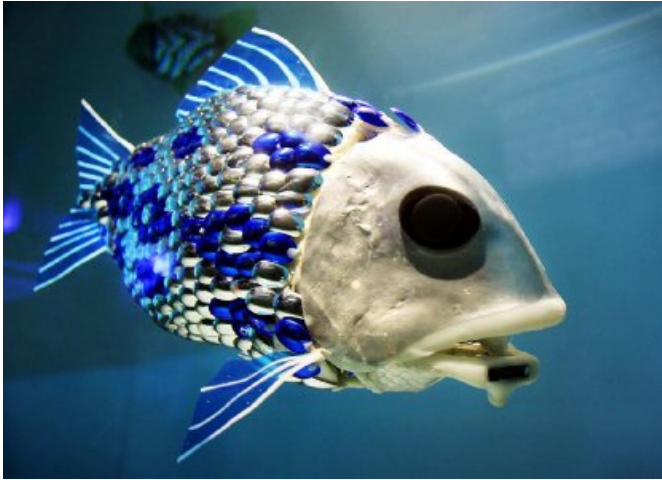
الروبوت RoboFish تم تصميمه في جامعة Essex البريطانية لإثبات إمكانية صنع نظام ملاحية يعتمد على التحرك بالتموج كالأسماك بدلاً من المحرك المعتمد على التربينات والمروحة اللولبية.
