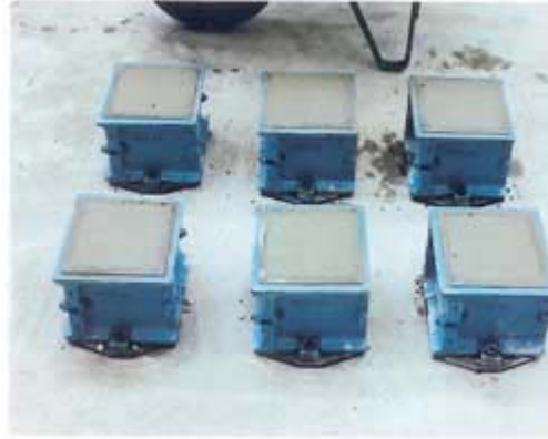
القوالب الخاصة بإختبار مقاومة الضغط بعد الإنتهاء من عملية التثبيت والتجهيز
