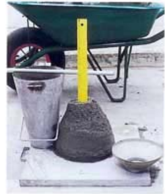
قياس مقدار الهبوط (slump) (الفرق بين ارتفاع القالب وكتلة الخرسانة)
