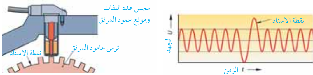
شكل (٢٥) مجس سرعة دوران المحرك وموقع عمود المرفق
