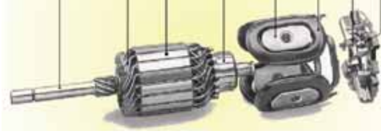
شكل (١٢) المحرك الكهربائي في البادئ
