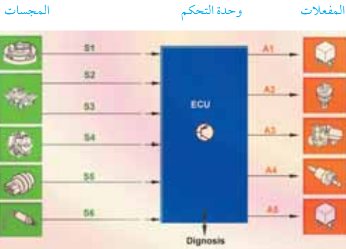
شكل (١٠) التحكم الالكتروني بنظام حقن البنزين المركزي
