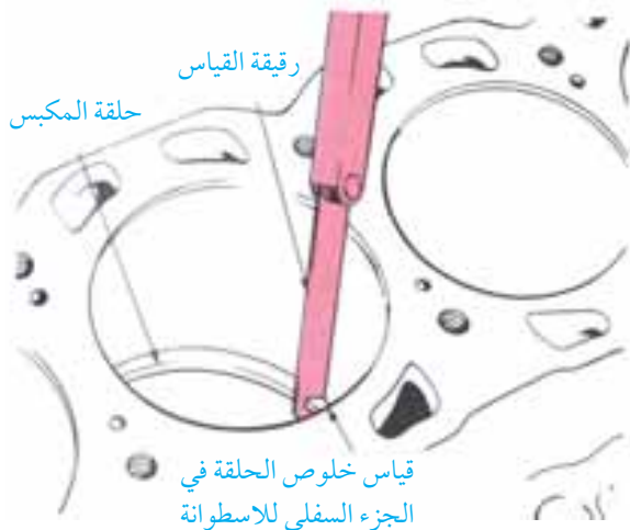
شكل (١١) قياس انغلاق حلقات المكبس
