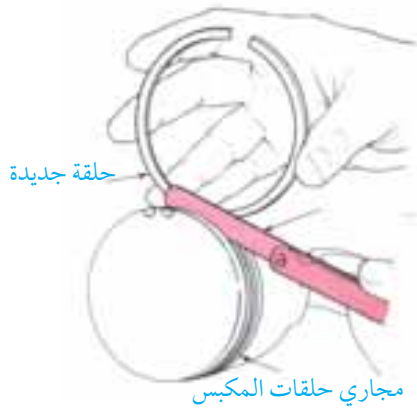
شكل (١٠) قياس زيادة الخلووص الجانبي لمجاري حلقات المكبس
