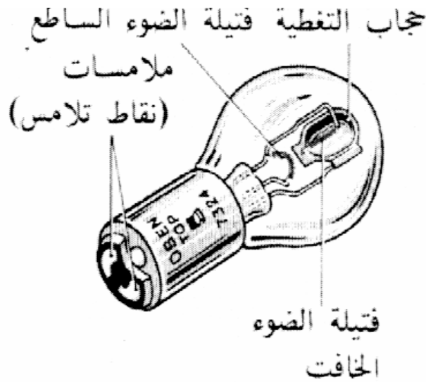
شكل رقم ( ٣ ) يوضح مكونات مصباح الإنارة
