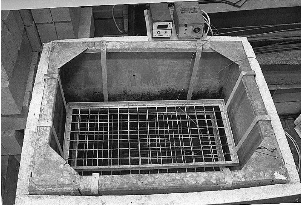
شكل رقم ٥,٣: خزان للعينات الخرسانية المعالجة بالبخر
