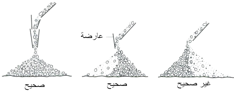
شكل رقم ٦,١: طريقة صب الخرسانة لتفادي انفصال حبيبات الركام
