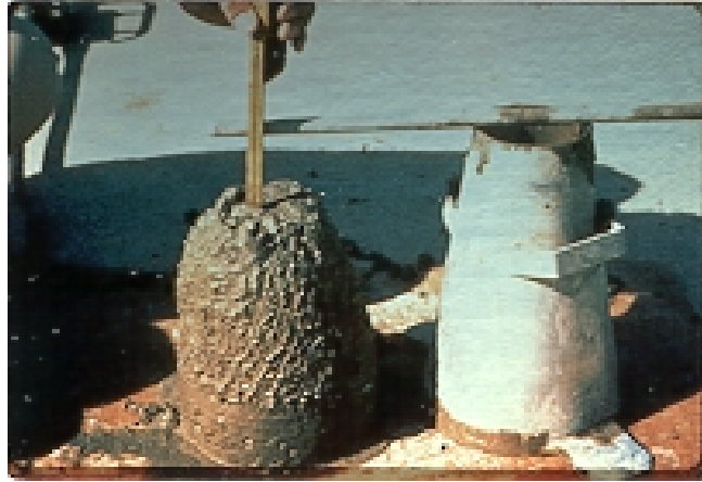
شكل رقم ٣,٦: يبين قياس هبوط الخرسانة .
