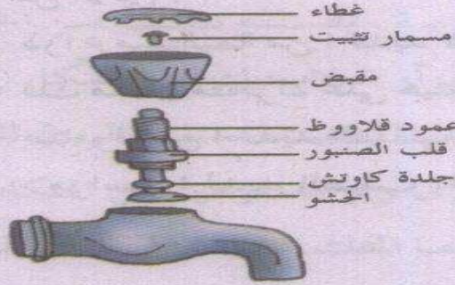
شكل (٣٩) صنبور المياه وأجزاؤها
