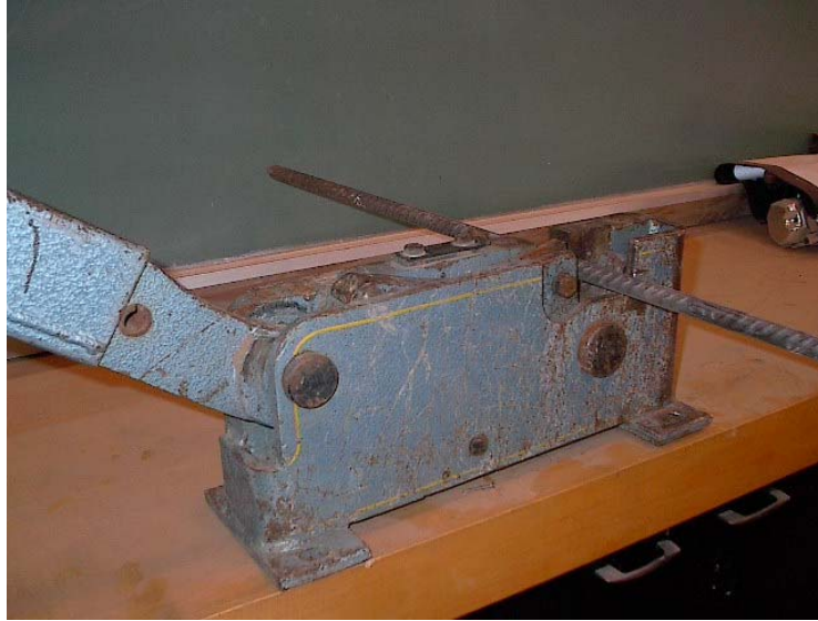
شكل رقم (٦٤) مقص لتقطيع الأقطار المختلفة للحديد
