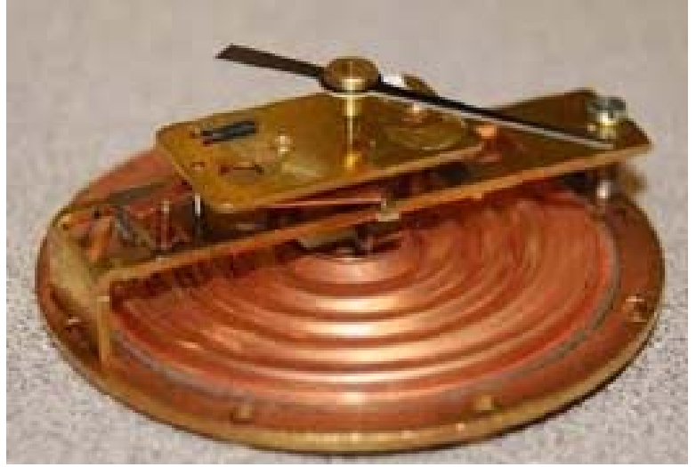
مبين ضغط ذو غشاء Diaphragm من النحاس
