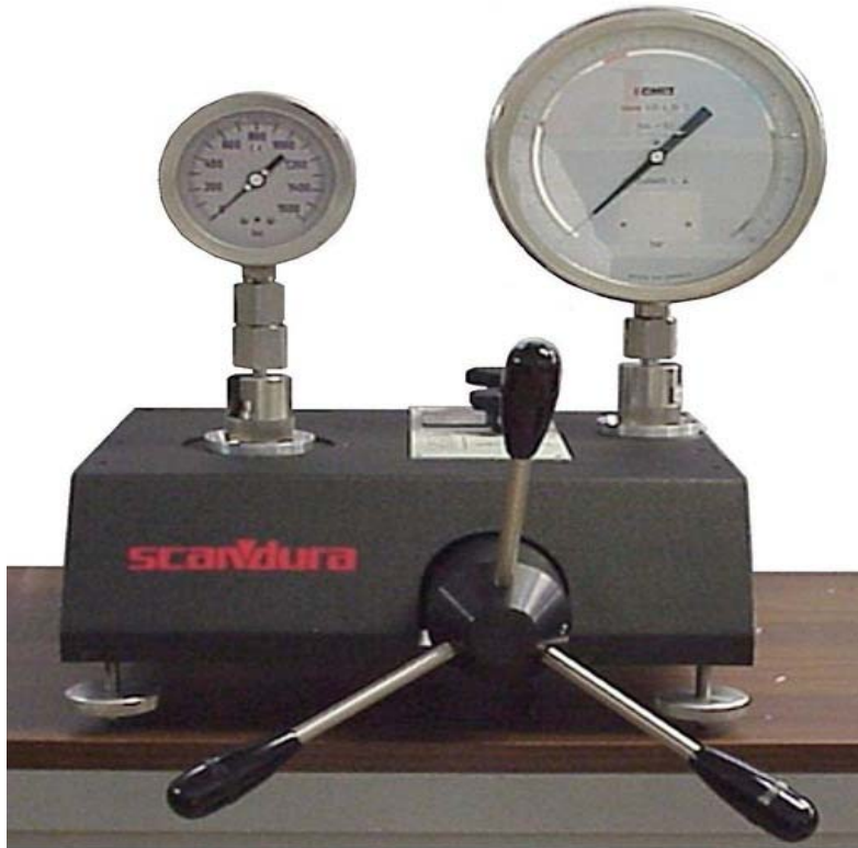
مضخة زيت لإختبار ومعايرة مبين ضغط باستخدام مبين ضغط عياري
