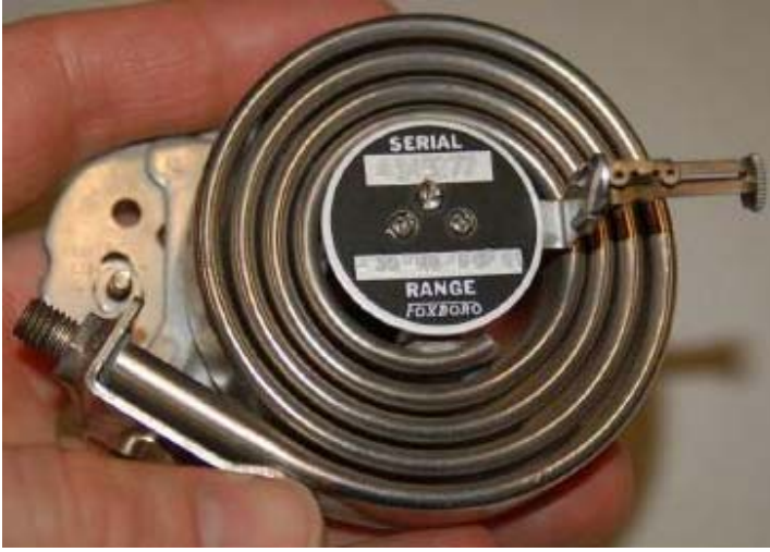
أنبوب بوردن علي شكل ملف Coiled or Spiral
