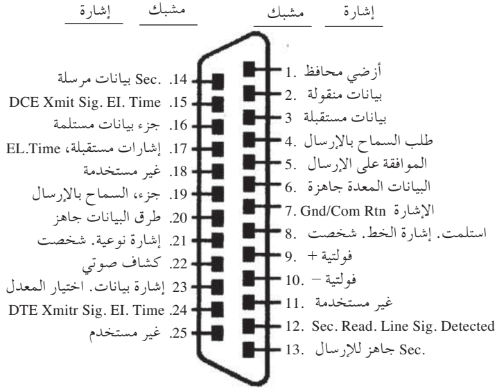
الشكل 29-4: وصلة الكمبيوتر RS-232 نوع D ذات الـ 25 مشبكاً.
