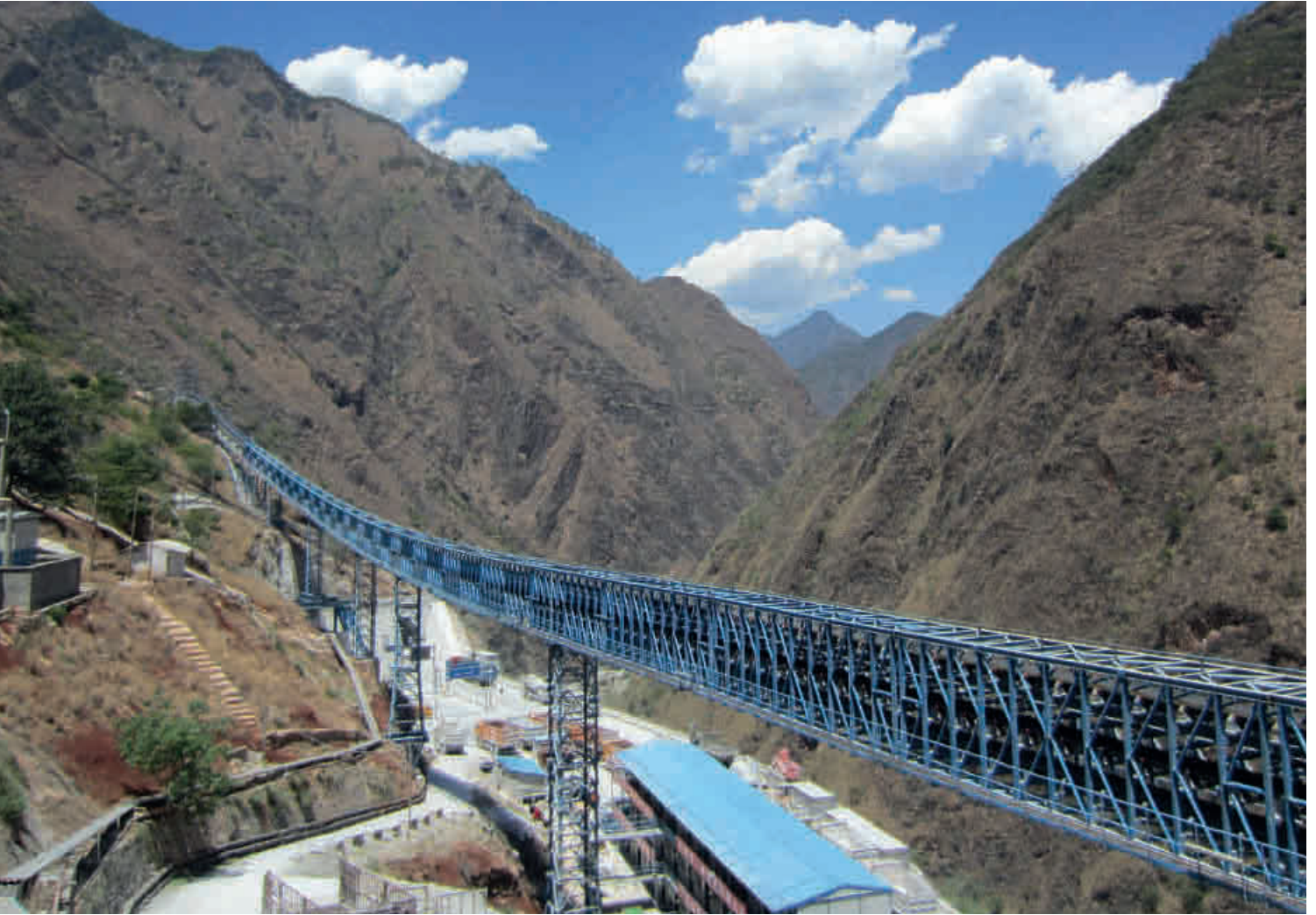
حزام ناقل يزيل الصخور من مختبر جن بنج، موقع تجربة المادة المظلمة بعمق 2500 متر تحت الأرض.
