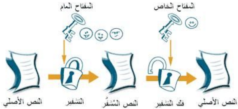
صورة ٣: توضيح عمل التشفير باستخدام المفتاح العام والمفتاح الخاص
