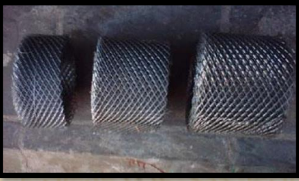
الشّد الممدد المستخدم في تغطية مواسير الكهرباء
