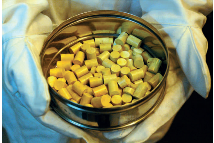
يمكن لحبيبات ثاني أكسيد الثوريوم أن تُستخدم كوقود نووي في المستقبل، إذا أمكن معالجة المخاوف المتعلقة بانتشار الأنشطة النووية.
