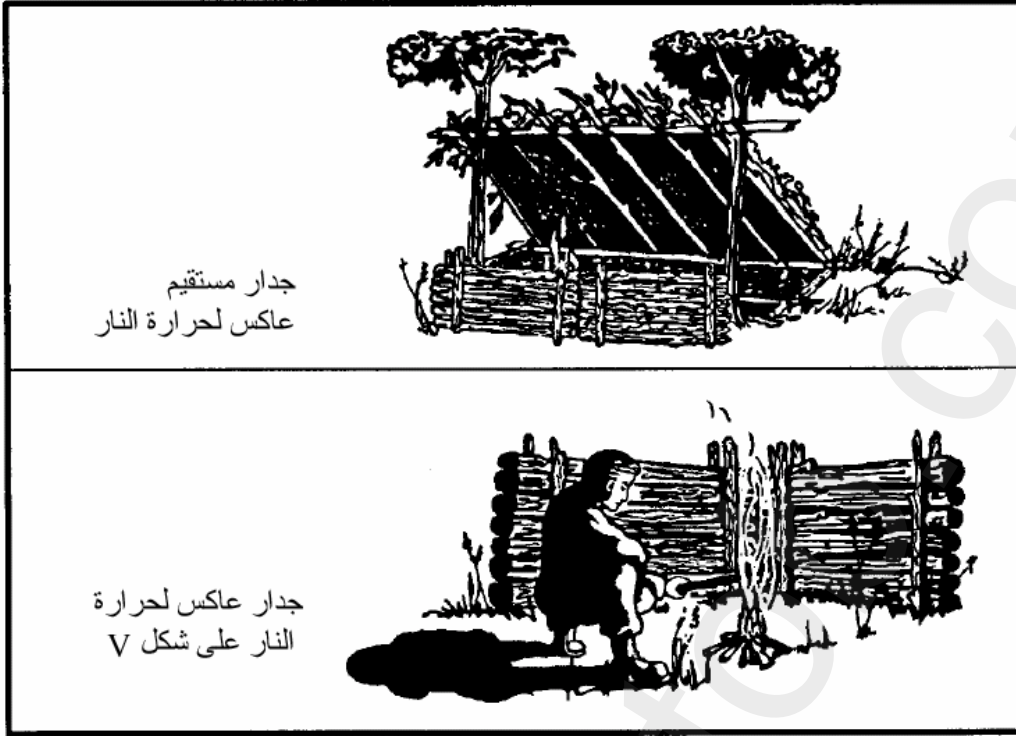
شكل 7-1 أنواع الجدران العاكسة لحرارة النار
