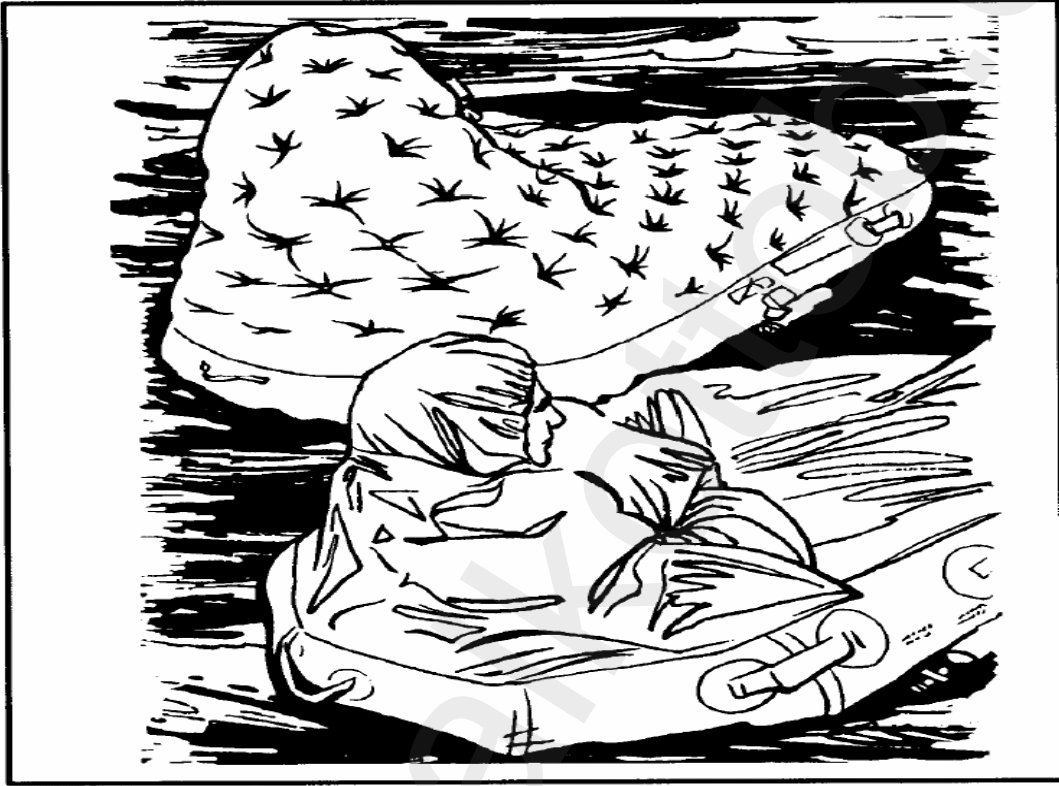
شكل 16- 11 قارب نجاة لشخص واحد بعد نفخ غطاء الرذاذ
