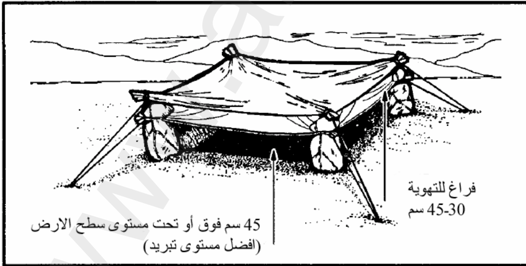
شكل 5-15 مأوى الصحراء المفتوح
