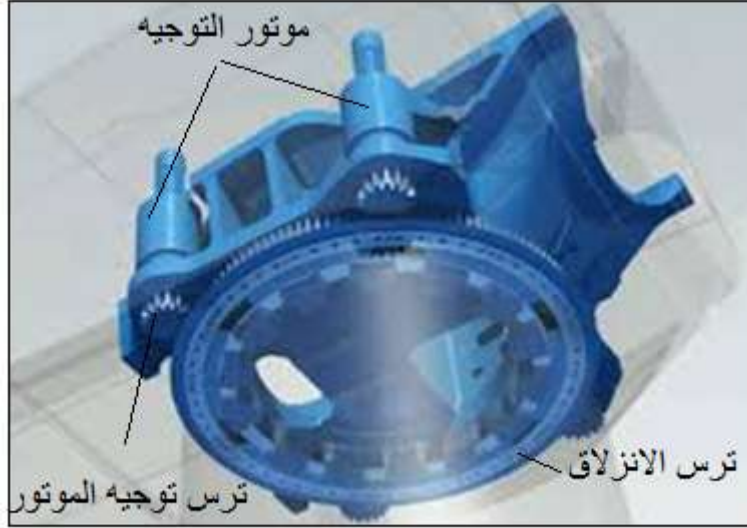
الشكل رقم (١٨) : منظومة التوجيه في التوربينة
