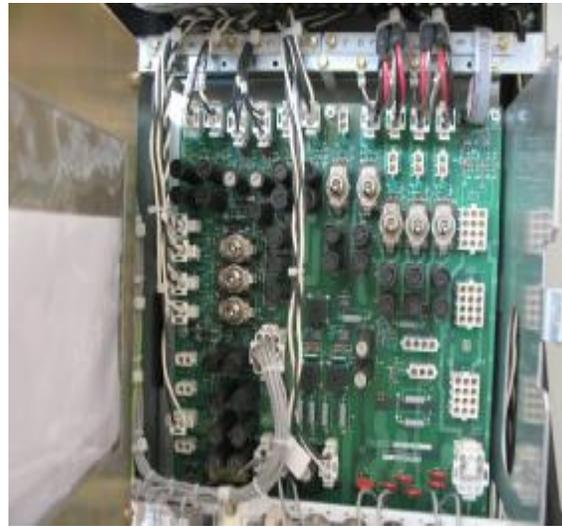
و-(QD1 core):يستخدم لاستقبال او ارسال اشارات من نوع ( digital 125 V DC) ويحتوي على (24 V Relays) يتم السيطرة عليها عن طريق ( R,S,T cores) ويحتوي على الاجزاء التالية
