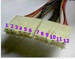
Connecteur d'une alimentation AT
