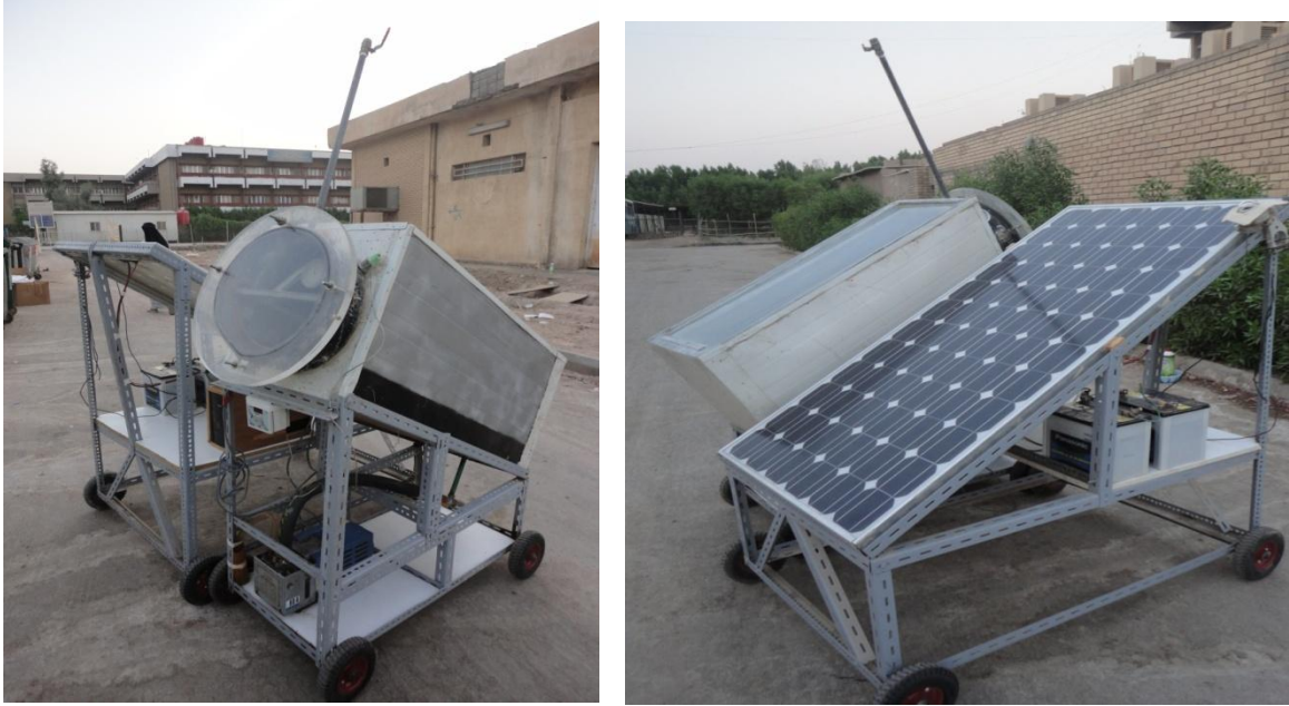
شكل 1: صورتان فوتوغرافيتان للمجفف الشمسي تحت التفريغ.
