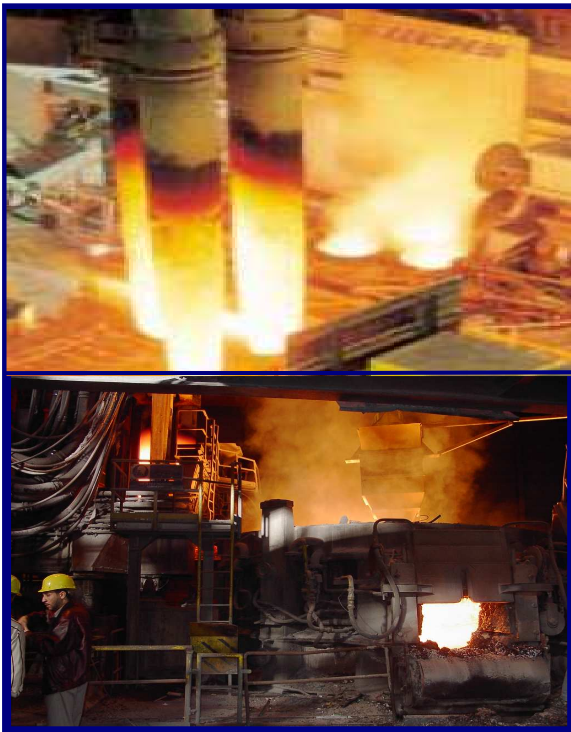
الصورة توضح فرن صهر بالقوس الكهربائي
