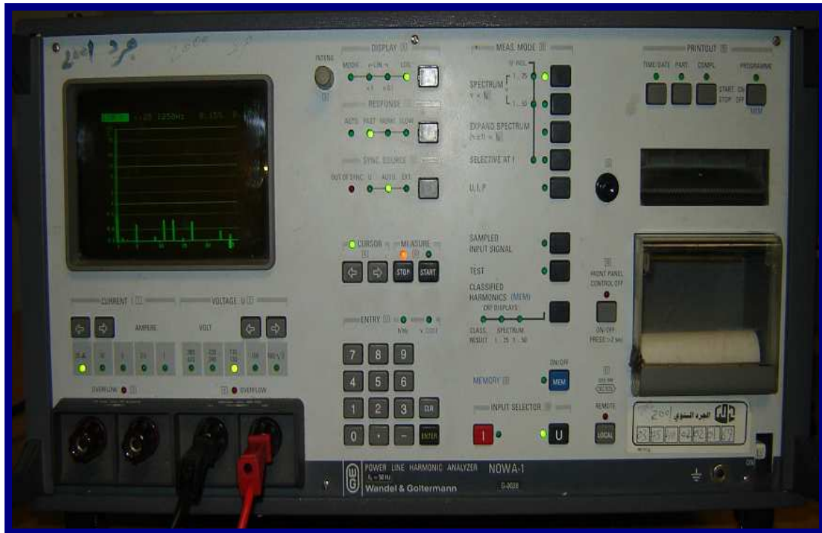
الصورة توضح جهاز قياس التوافقيات ( Power Line Harmonic Analyzer )
