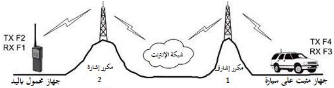
الشكل 8.1 يبين الية ربط مكرري إشارة مع بعضهما البعض لزيادة نطاق التغطية اللاسلكية
