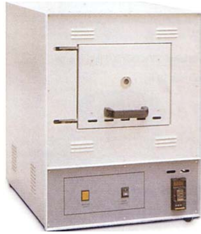
شكل ( ٦ - ٢١ ) فرن كهربائي خاص بالمعالجات الحرارية
