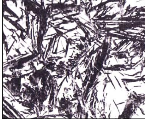
شكل ( ٦ - ٢٢ ) صورة مجهرية توضح التركيب الدقيق ( البنية الدقيقة للمارتنزيت ) عند تكبير 1:1220
