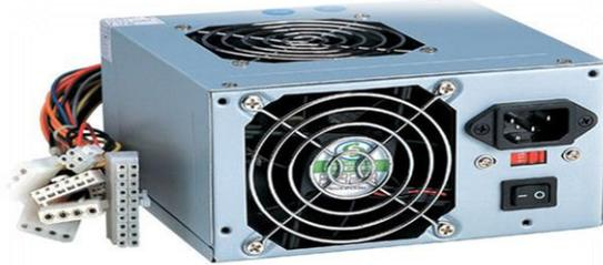
الباور سبلاى هو منفذ التغذية الكهربيه لجميع قطع الهارد وير داخل جهاز الكمبيوتر ، لذلك الدليل الوحيد على عدم سلامة هو عدم وصول طاقة كهربيه لتشغيل القطع ويمكنك الإستدلال على ذلك من خلال مراقبة مروحة الفان الخاصة بالمعالج عند بدء تشغيل الجهاز
