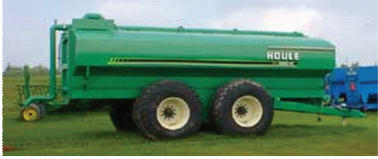
الشكل 6: صهريج عادي (غير مضغوط) لخن ونقل الأسمدة العضوية السائلة والردغية. (المصدر: www.ptth.tnempiuquesdlorah.moc/luoh.lmth ).
