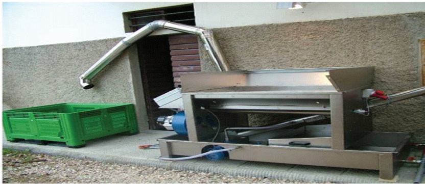
الشكل 16: آلة نزع ورق الشجر وتنظيف الزيتون وغسله.
