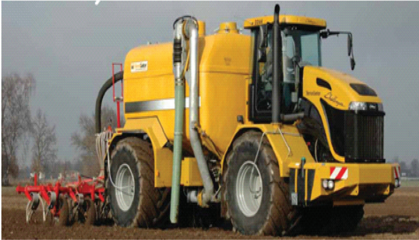
الشكل 5: صهريج ذاتي الدفع (المصدر: الكُتَيْب Challenger Terra-Gator 2244/3244).
