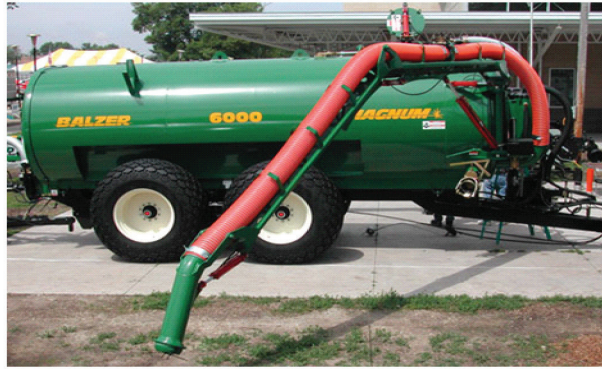
الشكل 7: صهريج خزن ونقل مضغوط للأسمدة العضوية السائلة والردغية. (المصدر: www.cnirezlab.moc ).
