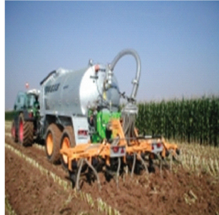
الشكل 12: أدوات للحقن المباشر لأسمدة عضوية سائلة وردغية تحت سطح التربة. (المصدر http://www.joskin.com ).
