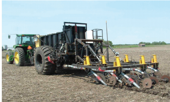
الشكل 27: نموذج أولي لناشر روث دقيق مع منظومة نشر تحت سطح التربة.
