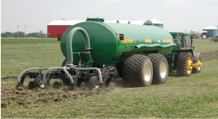
الشكل 8: صهريج مقطور بجرار لنقل الأسمدة العضوية السائلة والرديعية. (المصدر: www.cnirezlab.moc ://ptth).
